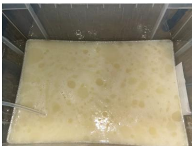
Fig. 1 オイル中の気泡生成実験。実験油槽内で気泡を発生させ、気泡生成条件および観察条件を確認した。
